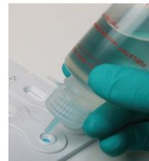
Figure 3 FUELSTAT *resinae* PLUS test
